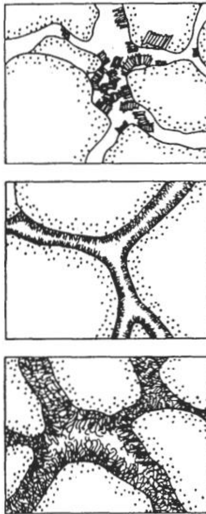
Figura 4.30. Tipos de lutitas dispersas: (a) caolinita en partículas de hormigón, (b) clorita que recubre los poros y (c) illita que puentea los poros [20].
