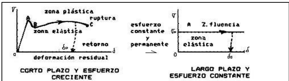
Figura 50. Carga creciente instantánea y carga constante prolongada.
