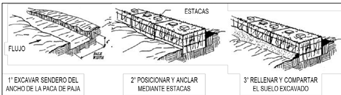
Imagen 21: Proceso de instalación de pacas de paja
