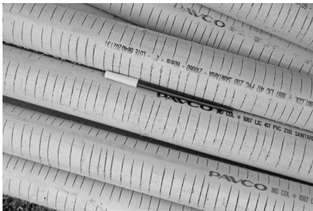
Fotografía 2.6 Ranuras cortadas manualmente para los subdrenes de penetración.
