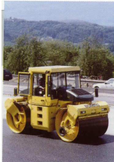
Foto 18: Compactador tipo Tandem.
