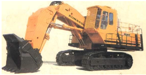
Foto 10: Excavadora Frente Pala.
