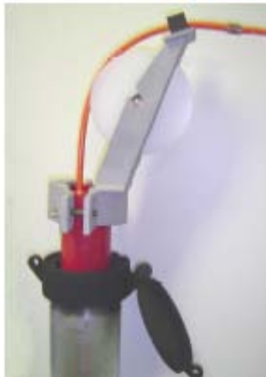
Figura 5.6 Adaptación de la polea en el cabezal del tubo guía del inclinómetro (cortesía de Geokon)
