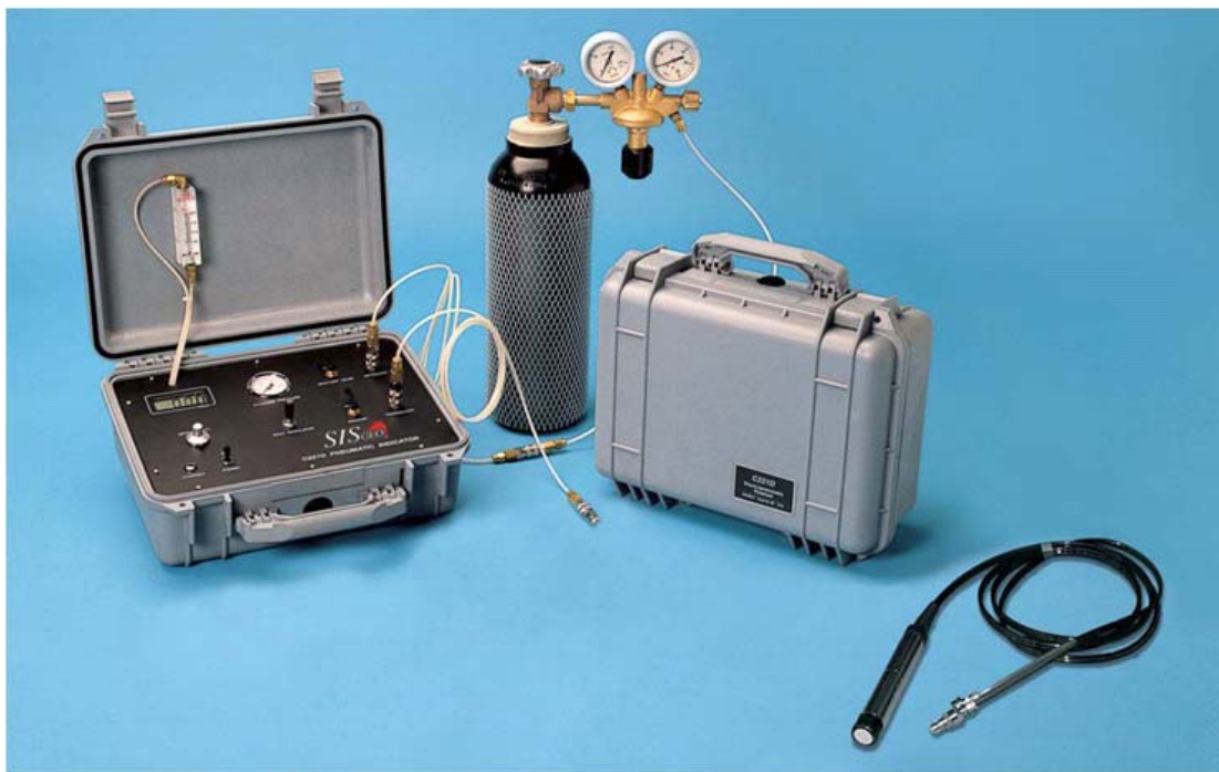
Figura 6.18 Sistema de toma de lecturas de piezómetro neumático: a) Diagrama del sistema, b) Gabinete de activación (cortesía de Sisgeo)
