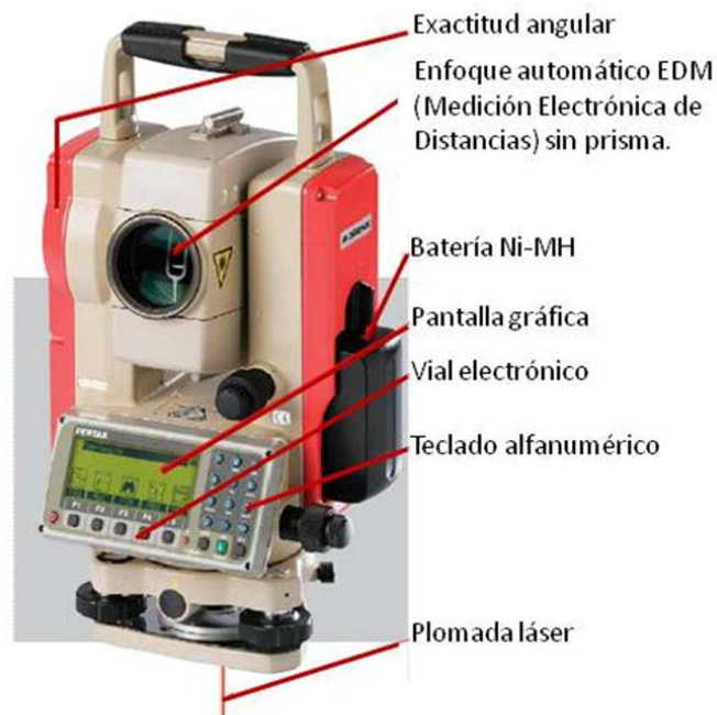
Figura 4.21 Partes de la estación total modelo R300 (cortesía de Pentax)
