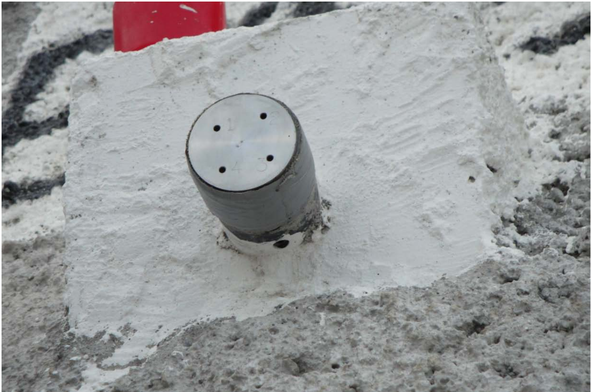
Figura 5.58 Cabezal de referencia de un extensómetro interno de barras con numeración en la superficie para la identificación de cada barra
