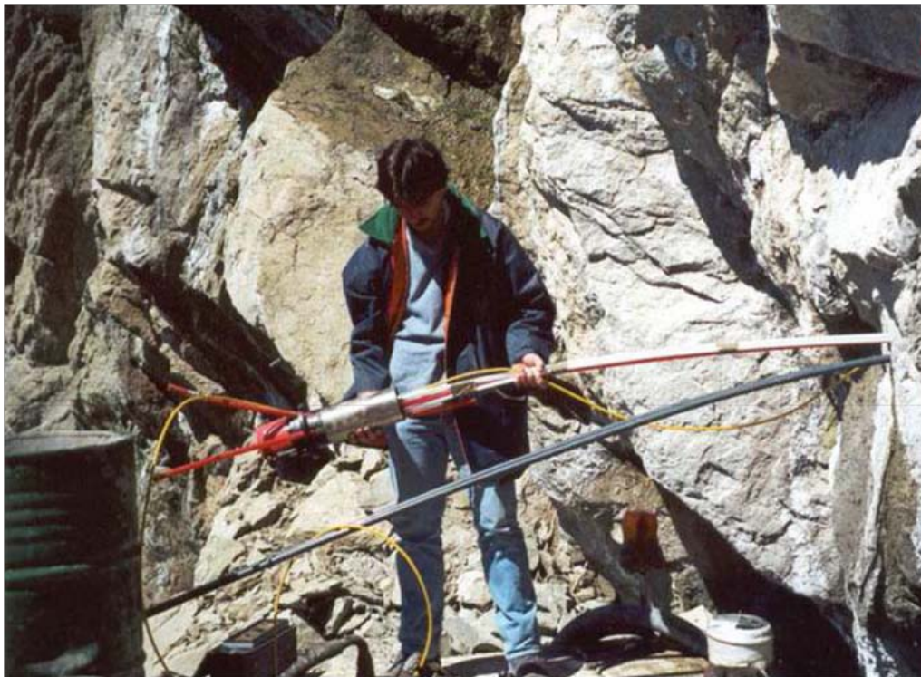
Figura 5.61 Instalación de un extensómetro interno de barras (cortesía de Sisgeo)
