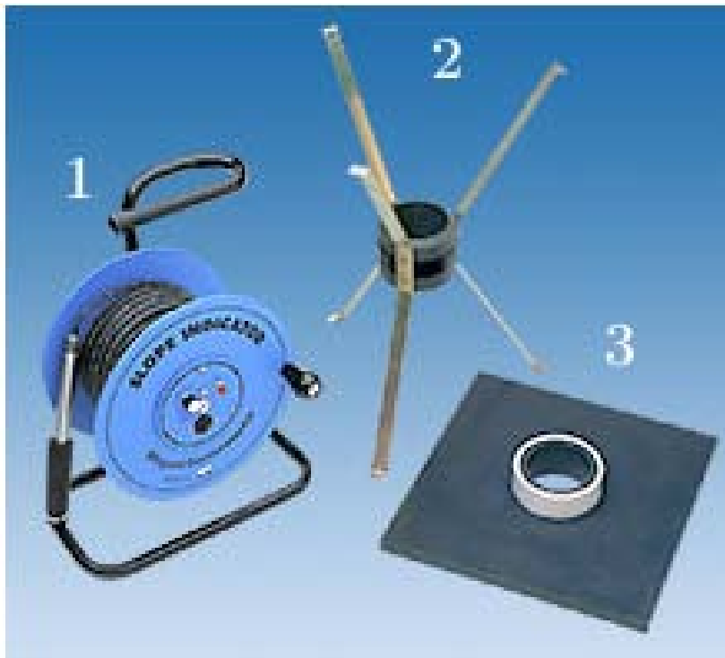
Figura 5.68 Deformómetros magnéticos: 1) Carrete eléctrico graduado con sonda, 2) Araña magnética y 3) Placa con imanes (cortesía de Slope Indicator)
