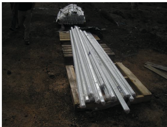
Figura 17. Bulones de fibra de vidrio.
