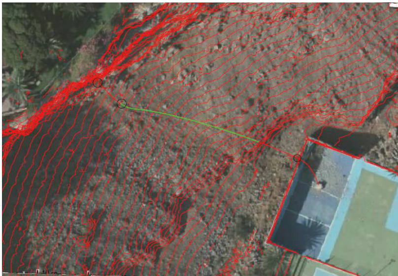
Figura 5. Deducción de la trayectoria seguida por el desprendimiento ocurrido en septiembre de 2011.
